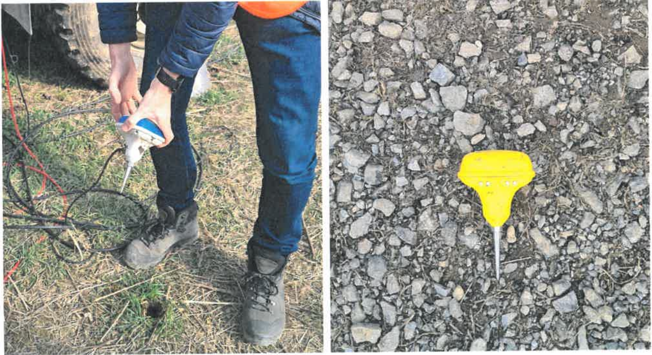
Slika 5. Prikaz geofona (prijamnika)
